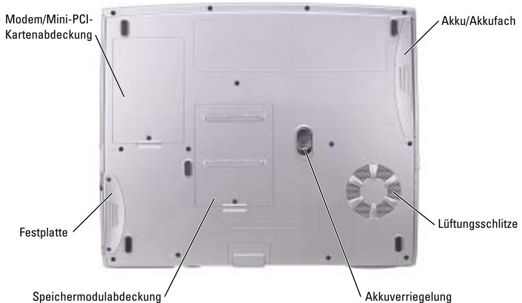
**MODEM/MINI-PCI-KARTENABDECKUNG** — Deckt das Fach für Modem und Mini-PCI-Karte ab. Siehe Seite 82.
