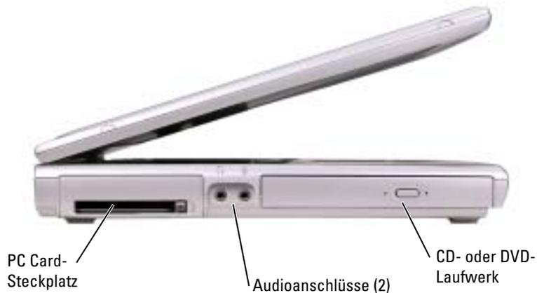
**PC CARD-STECKPLATZ** — Unterstützt eine PC Card wie z. B. Modem oder Netzwerkadapter. Weitere Informationen finden Sie in der Hilfedatei *Dell Latitude 100L-Hilfe* unter „Verwenden von PC Cards“. Hinweise zum Öffnen der Hilfedatei finden Sie auf Seite 16.
