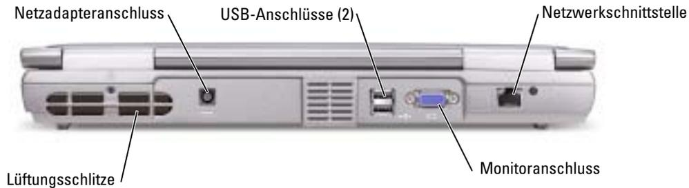
**LÜFTUNGSSCHLITZE** — Der Computer ist mit einem integrierten Lüfter versehen, der Luft durch die Lüftungsschlitze ansaugt, um einer Überhitzung des Computers vorzubeugen.
